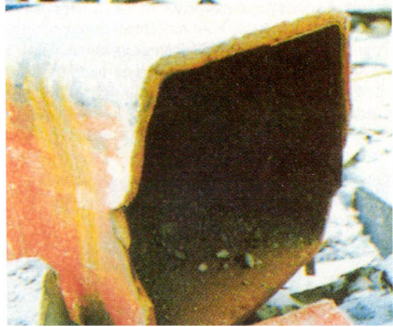
Resim 3. Tam nüfuziyetli kaynağa sahip bir kolonda kırılma (Kobe depremi sonrası)
