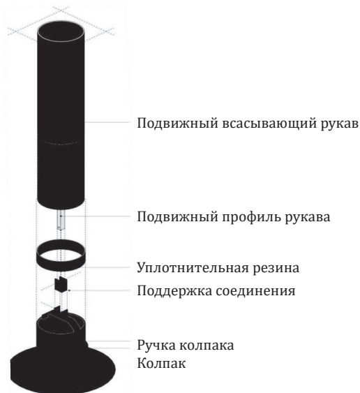
Рисунок 7 : Детали подключения вытяжки
