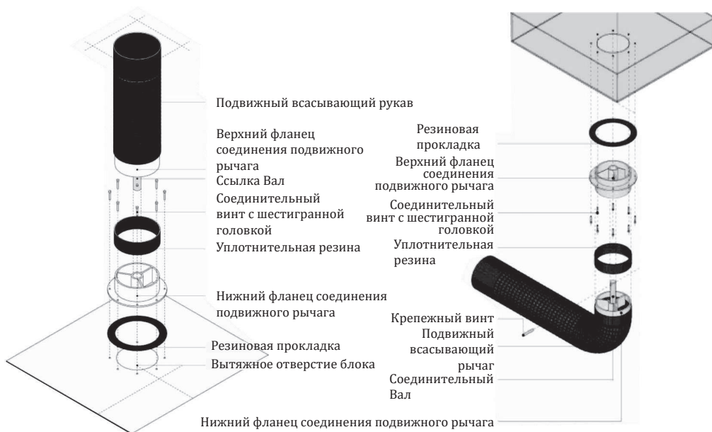
Рисунок 6 : Детали соединения всасывающего рукава в моделях DFS 1S, DFS 2S, DFS 1SK, DFS 2SK.
