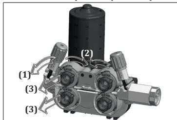
Figura 6: Remoção do rolo de avanço de fio
