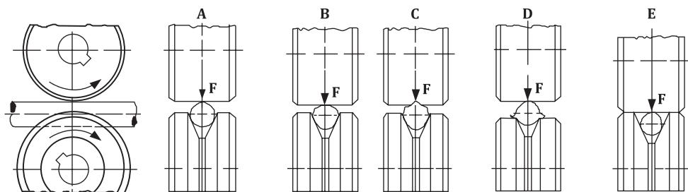
Figura 9 : Errores de configuración de impresión y selección de rodillo
