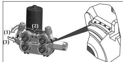
Figuur 9 : De draad op de spoel aanbrengen
