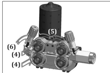
Figuur 7 : Plaatsing van de draadaandrijfrollen
