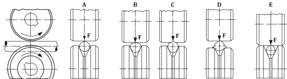
Рисунок 9 : Настройка прижима и ошибки выбора катушки
