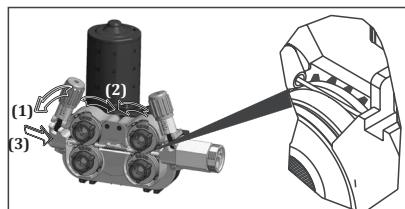
Figur 8 : Anbringen des Drahtes auf der Spule
