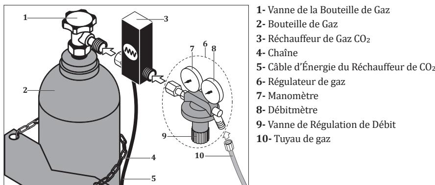
**Figure 3 : Branchements de la Bouteille / du Réchauffeur / du Régulateur de Gaz**
