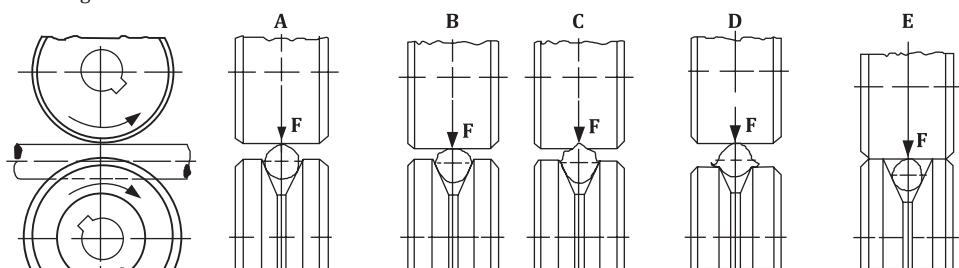
Figure 9 : Pression de réglage et la bobine de sélection erreurs
