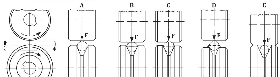
**Figur 9 : Fehler bei der Druckanpassung und Rollenauswahl**
