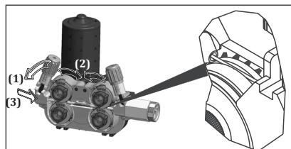
Figura 8 : Conducción del alambre al rodillo
