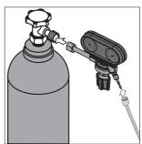
Figure 2 : Connexion de la bouteille de gaz
