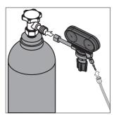
Şekil 2 : Gaz Tüpü Bağlantıları
